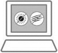
Die Anti-Glare Filter haften dank einer Silikonschicht direkt auf dem Display. Sie verringern Reflexionen durch das Innen- sowie Sonnenlicht und schützen das Display vor Kratzern.
