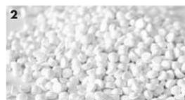
Diese Flocken werden erhitzt, um letzte Verunreinigungen zu beseitigen, dann geschmolzen und in dichte **Pellets** umgewandelt.
