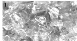
Anstatt verbrannt zu werden, werden gebrauchte Trinkflaschen gesammelt, nach Farben sortiert und gewaschen. Nach dem Entfernen der Etiketten und Verschlüsse werden die Flaschen zerkleinert und in **PET-Flakes** geschnitten.
